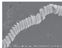
図5 金属ガラスの切りくず
