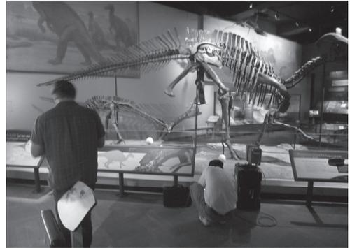
図3 Faro レーザースキャナーによるParasauroplophusの3次元スキャン計測
