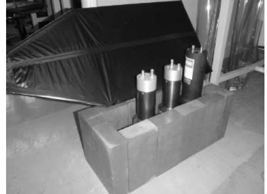
図2 製作中の雷ガンマ線検出器。上面以外を遮蔽するように3台のシンチレーション検出器を取り囲んでいる。黒い光遮蔽シートの中にはプラスティックシンチレーターの平板が入っている。
